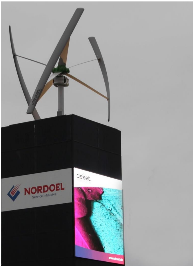
Bild 2: LED Videodisplay am Nordoel-WinTower mit 3,9mm PixelPitch
